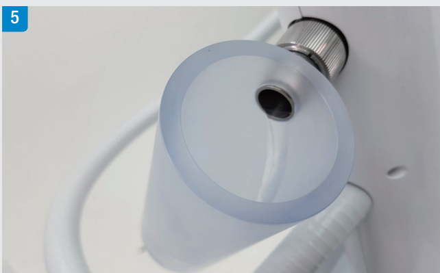
5 בדוק כי השמן מנוקז היטב דרך מחבר אוסף השמן. השאר את אוסף השמן מחובר עד שהשמן נוקז לגמרי מהמערכת. לאחר ניקוז מוצלח, הוצא את אוסף השמן ממעמד הזרוע בסדר הפוך
