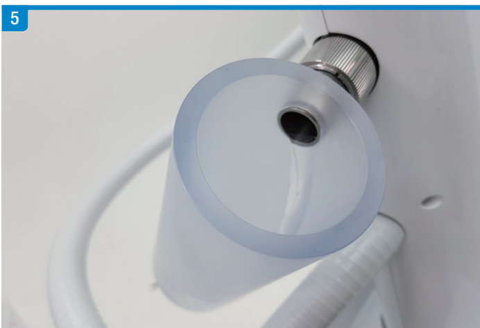
5 בדוק כי השמן מנוקז היטב דרך מחבר אוסף השמן. השאר את אוסף השמן מחובר עד שהשמן נוקז לגמרי מהמערכת. לאחר ניקוד מוצלח, הוצא את אוסף השמן ממעמד הזרוע בסדר הפוך.
